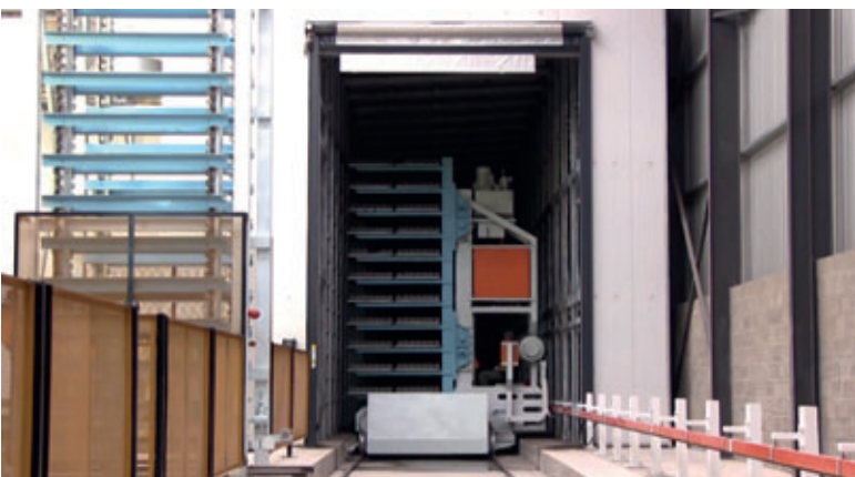
Portón de apertura rápida (lona): una solución rentable y sencilla para una apertura y cierre rápidos, lo que permite un funcionamiento perfecto del carro multifuera con una pérdida mínima de calor y humedad de la cámara de curado con un ambiente uniforme
