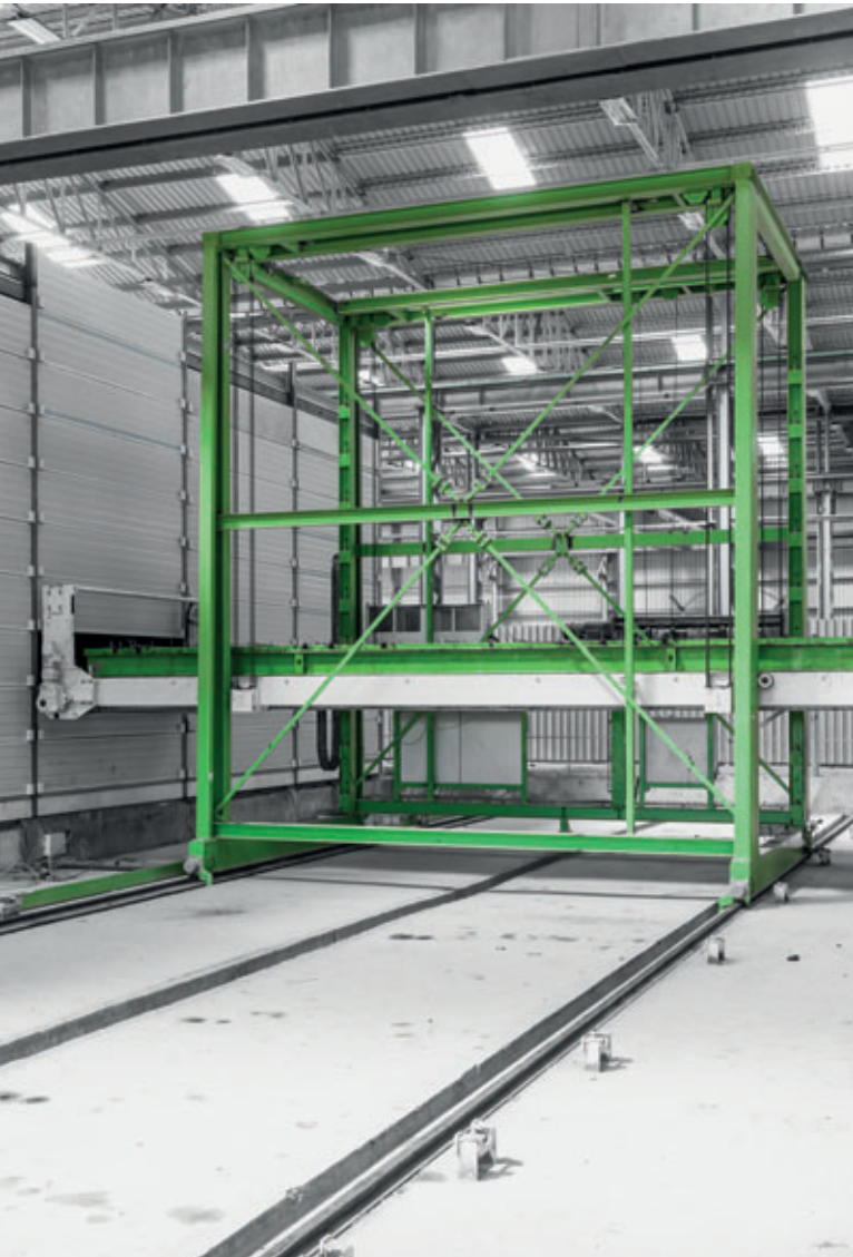
BGSCTPL ha construido recientemente tres líneas de producción de Elematic en Nueva Delhi para prefabricados de hormigón: instalaciones de carrusel para grandes placas de forjado, placas de muro especiales y pilares 3S
