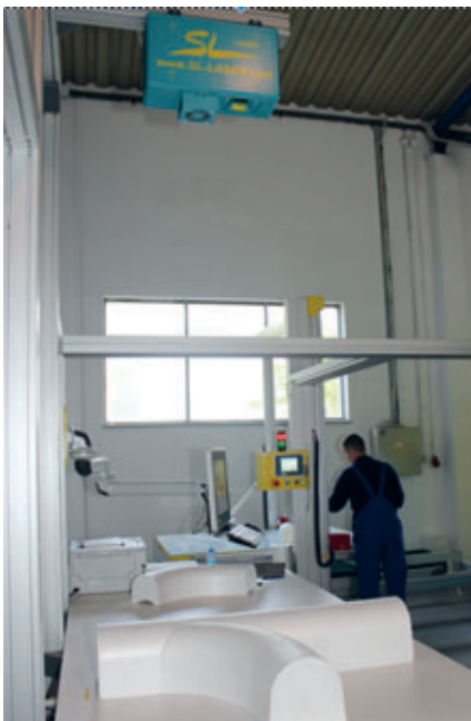
Del control del posicionamiento exacto de las diferentes piezas se encarga un láser situado sobre la mesa de trabajo, que indica continuamente todas las líneas de la base de pozos sobre la mesa
