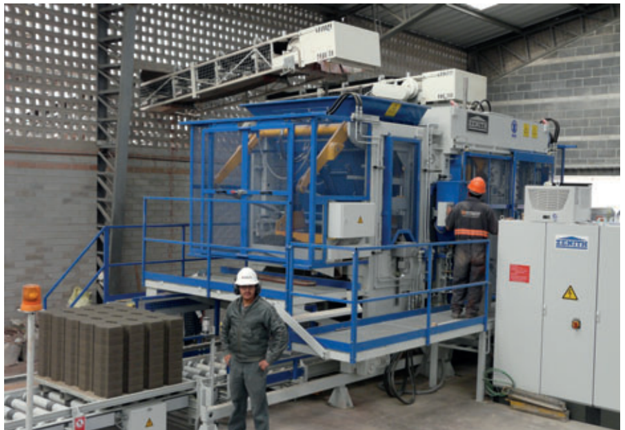
Zenith 844 SC Mehrlagenfertiger für Pflastersteine mit Vorsatzbeton
