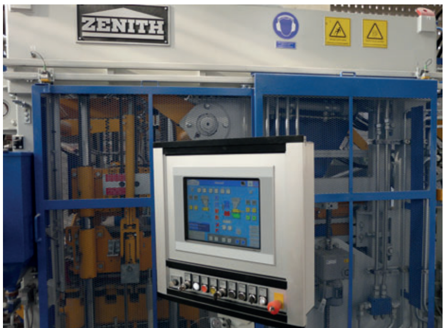
Vollautomatische Steuerung des Zenith 844 SC Mehrlagenfertigers
