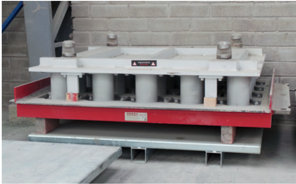
Pflastersteinforme von Kobra für anspruchsvolle Produkte
