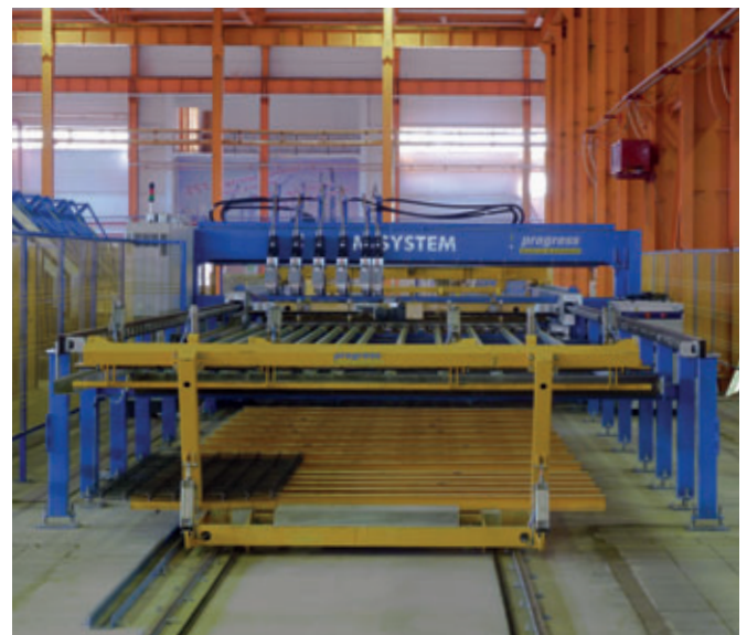
Die Mattenschweißanlage M-System Evolution erhält die erforderlichen Daten von ebos. Die Bewehrungsmatten werden just-in-time und exakt nach den erforderlichen Vorgaben produziert.
