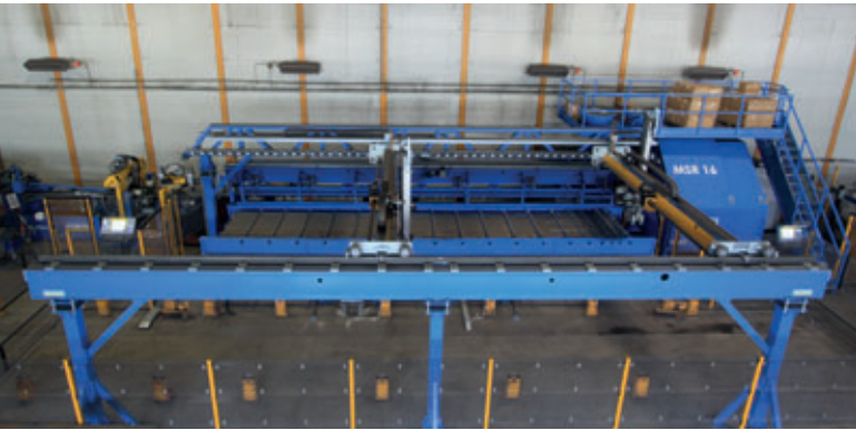
Die neue Produktionslinie für die Bewehrungsfertigung: VGA Versa (hinten links), MSR16 2BK (hinten) und der Bewehrungsroboter (vorne).
