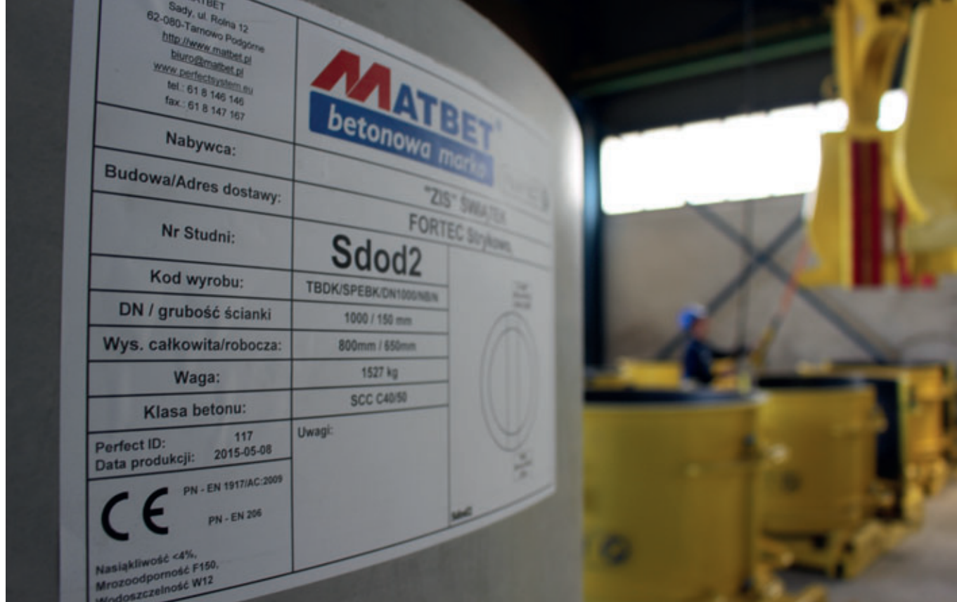
Die fertigen Betonschachtunterteile werden mit einem Aufkleber mit allen relevanten Daten und Parametern versehen.
