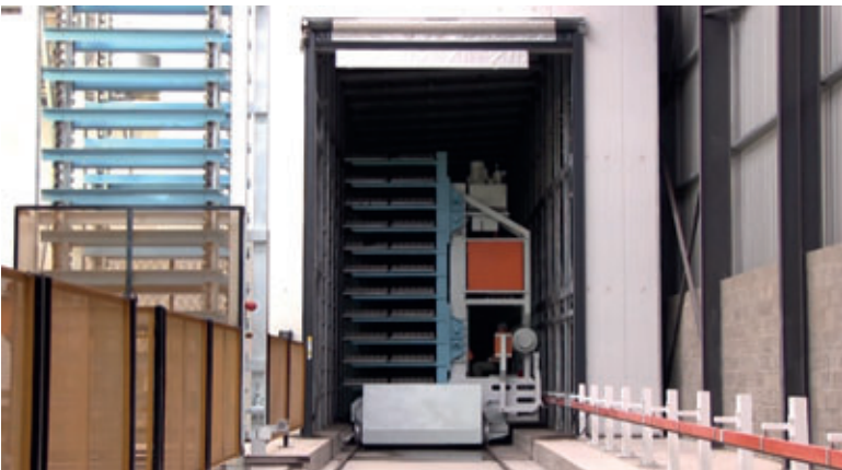
Schnellaufator (Plane) – eine wirtschaftliche und einfache Lösung zum schnellen Öffnen und Schließen, was einen nahtlosen Betrieb der Fahrzeuggruppe bei minimalem Wärme- und Feuchtigkeitsverlust der Härtekammer mit einheitlicher Atmosphäre ermöglicht.
