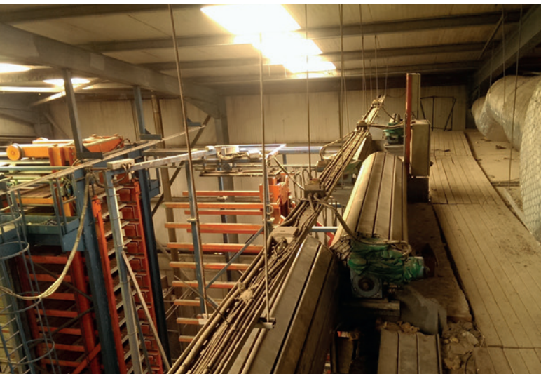
До: участок с передаточной тележкой – элеватор и опускное устройство
