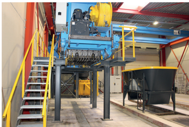
Слипформер Echo Precast Engineering в исходном положении
