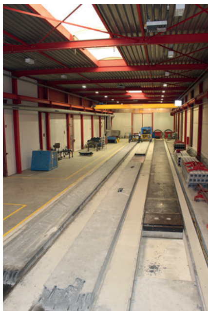
Производственные настилы на демонстрационном заводе Echo Precast Engineering
