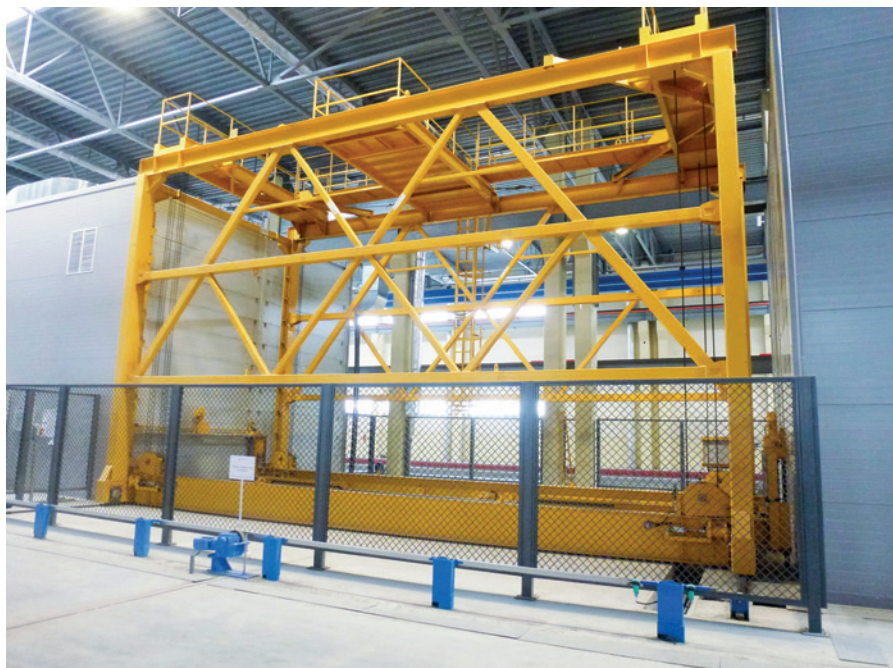
Подъемная платформа служит для загрузки и выгрузки поддонов в стеллажном блоке
