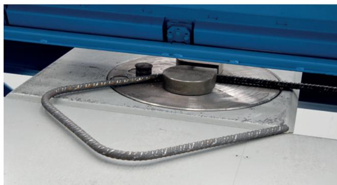
Рис. 2: Устройство двойной гибки со встроенными гибочными матрицами типа 2BK способно обрабатывать арматурные стержни длиной до 12 м
