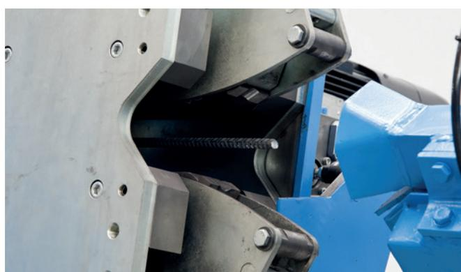
Рис. 4: Благодаря линейно выдвигающемуся ножу резка производится быстро и точно
