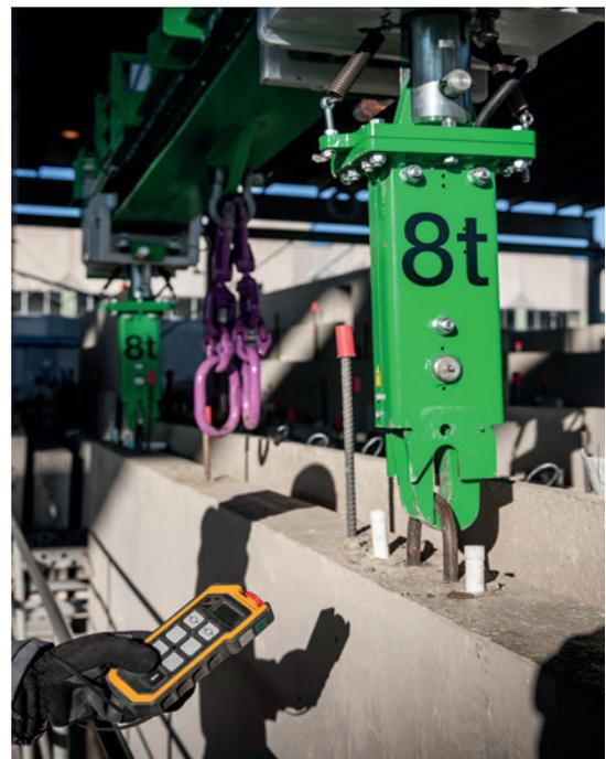
Отпадает необходимость в трудоемком креплении строп, поскольку траверса Elematic оборудована подъемными крюками
