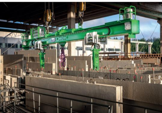
Грузоподъемная траверса Elematic E9-16-5a была разработана с целью повышения безопасности труда
