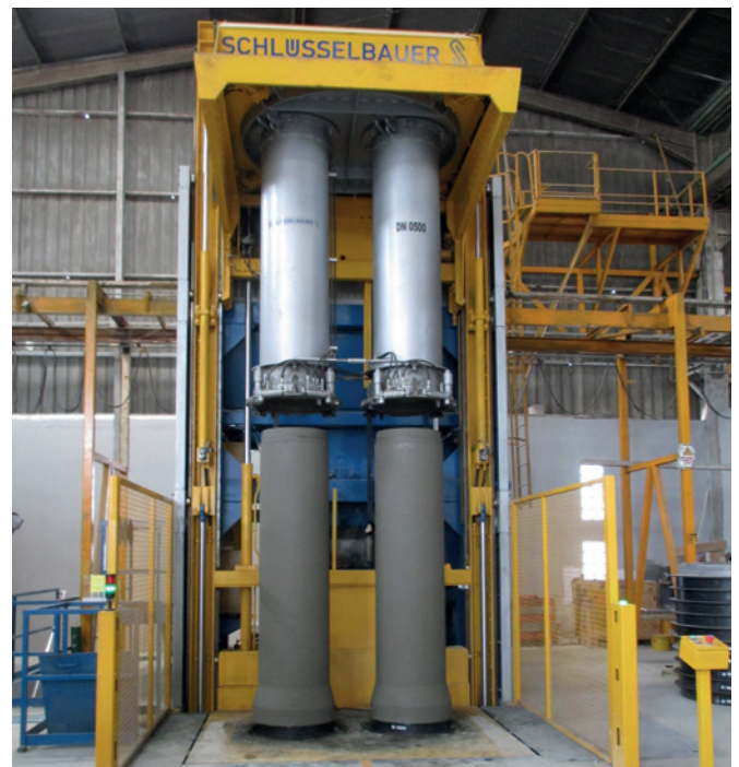
Установка Precise фирмы Schlüsselbauer Technology способна работать в сдвоенном или обычном режиме. При этом тактовое время для выпуска двух бетонных труб существенно сокращено
