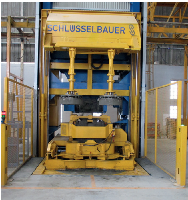
При помощи ленточного транспортера и загрузочной вагонетки бетонная смесь одновременно подается в две формы
