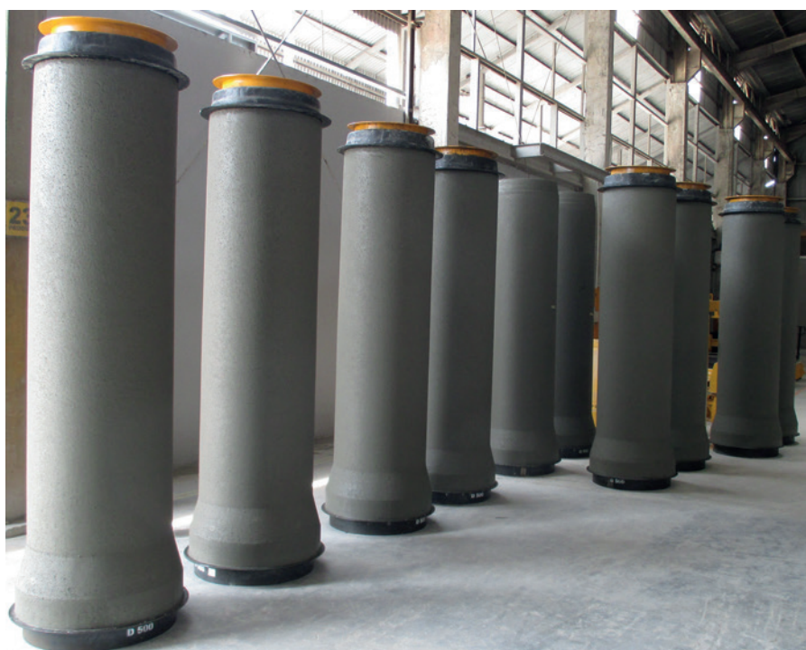
Как правило, бетонные трубы выдерживаются в течение рабочего дня
