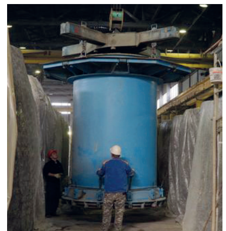
Установка Variant 2500 компании Prinzing-Pfeiffer
