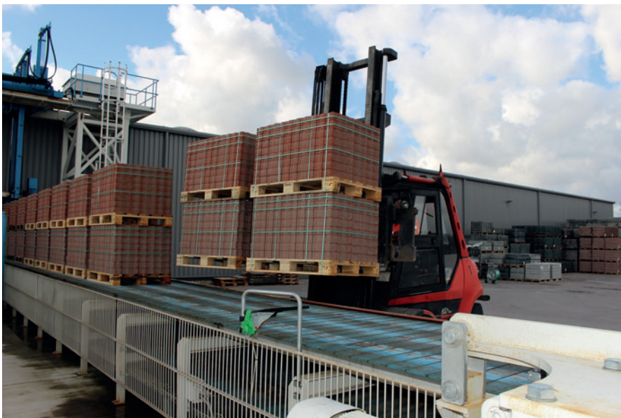
Вилочный погрузчик для транспортировки пакетов бетонных блоков оснащен двойным захватом для перемещения четырех пакетов за один раз
