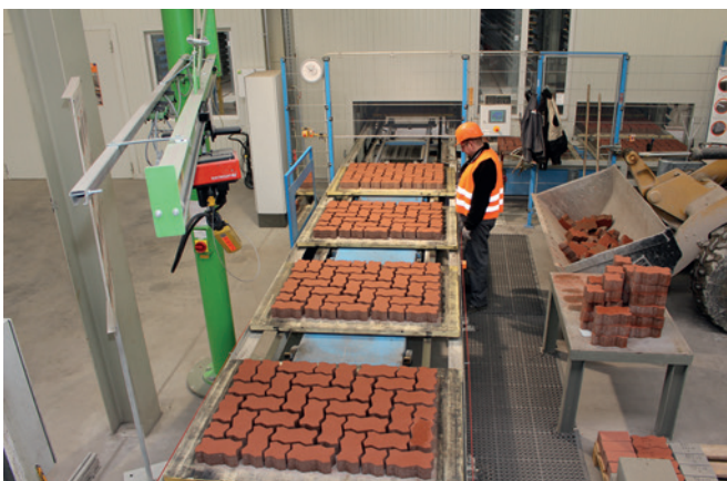
После станции разъединения две транспортнорочные линии вновь объединяются
