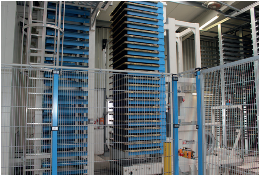
Транспортная группа Hess забирает поддоны с подъемников (вместимость подъемников – 23 поддона) и перемещает их в стеллажную камеру Rotho
