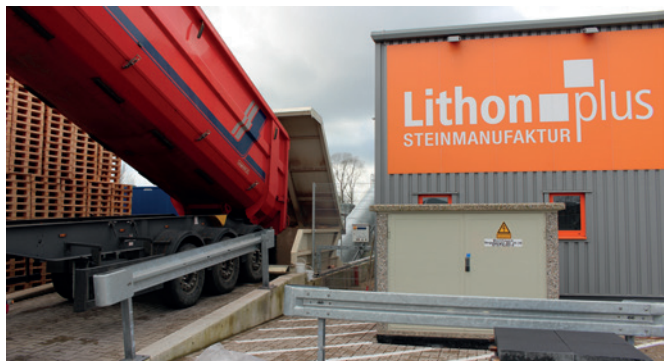
Поставляемые инертные разгружаются в приемный бункер емкостью 22 м 3
