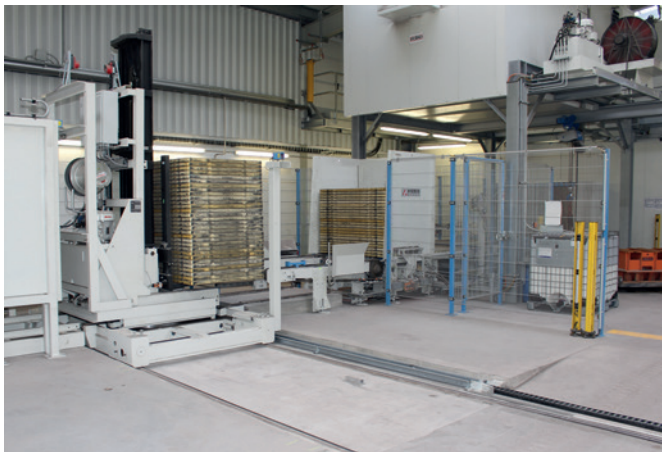
Транспортная группа накопителя поддонов доставляет технологические поддоны Assux к камнеформовочной машине
