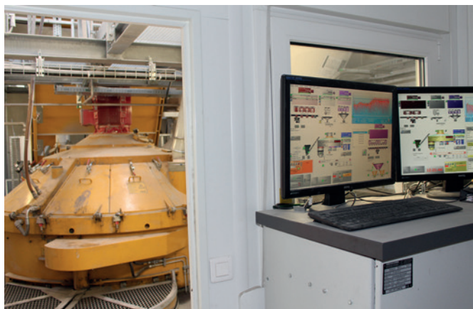
Всеми дозировочными и смесительными процессами управляет система Sauter
