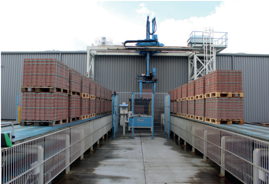
Роботизированный кран забирает пакеты вместе с деревянным паллетом и устанавливает их по два на один из параллельных буферных транспортеров
