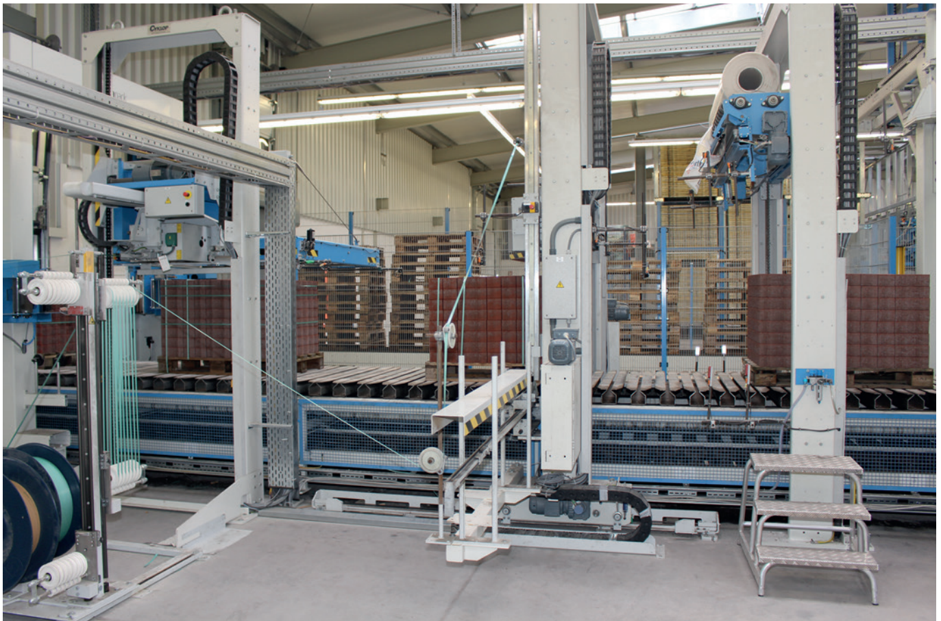
Готовые пакеты блоков обвязываются по вертикали и горизонтали и вывозятся на внешний склад
