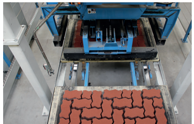
На этой станции блоки формируются в слои на поддоне
