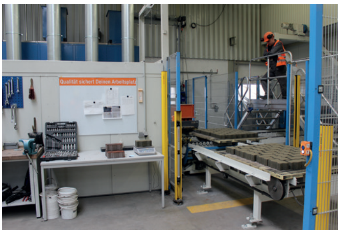
Для проведения контроля качества поддоны можно снимать с линии позади камнеформовочной машины
