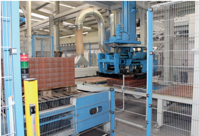
Сдвоенные слои укладываются на деревянные европаллеты, формируя пакеты изделий
