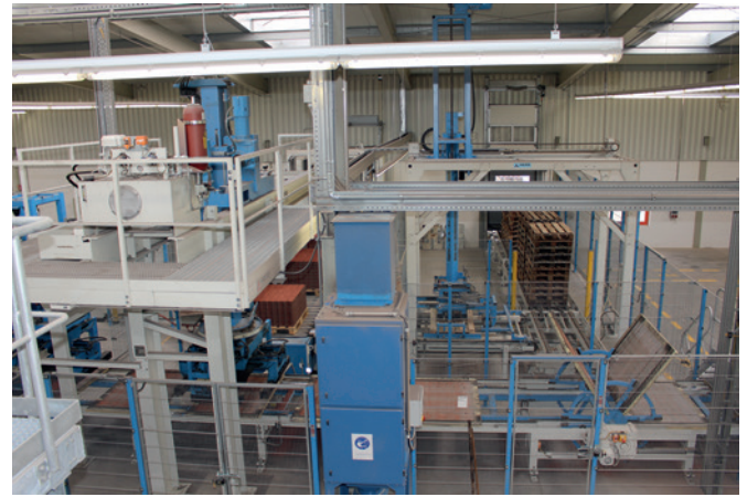
Пустые поддоны очищают, кантуют, штабелируют и отправляют на склад поддонов либо на камнеформовочную машину
