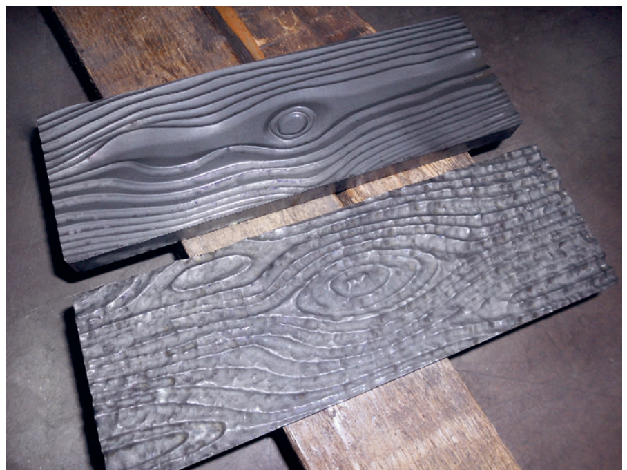
Образец матрицы для опытного производства бетонных блоков в уже имеющихся формах
