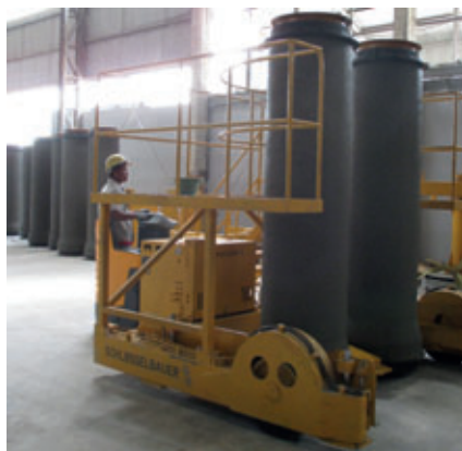
Il secondo operatore addetto alla produzione di tubi trasporta i prodotti freschi con l'apposito carrello verso il settore per l'indurimento.
