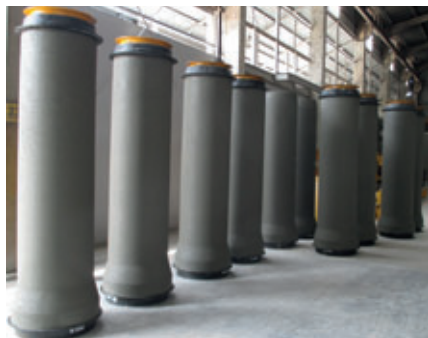
I tubi in calcestruzzo, in genere, restano un giorno lavorativo nel settore per l'indurimento.
