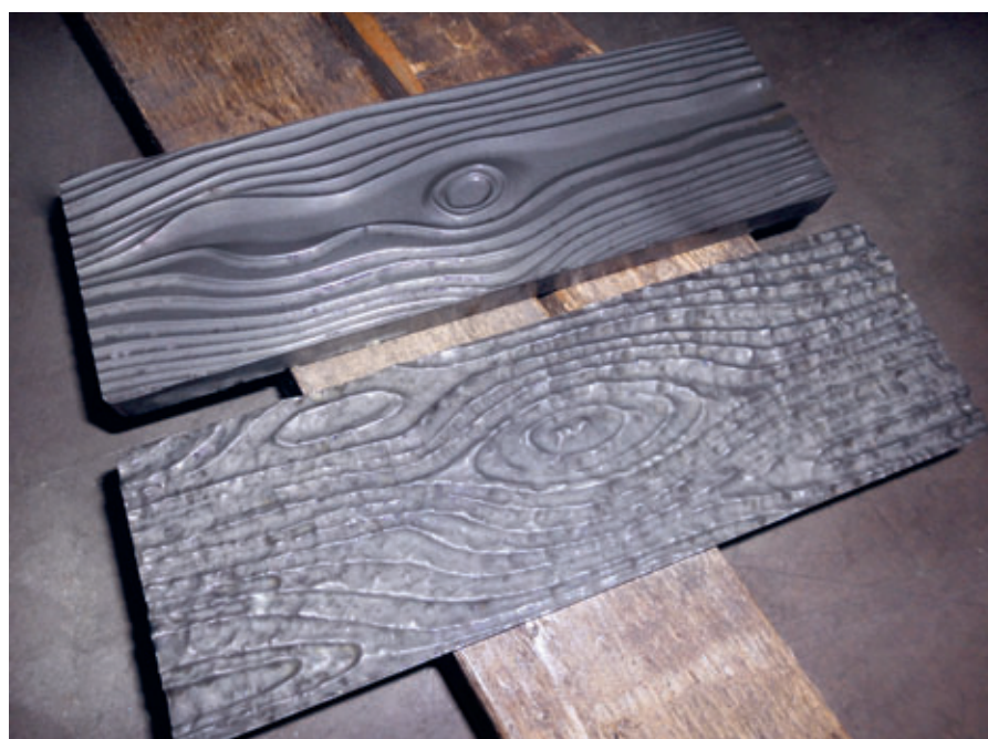
Piastra di pressione campione per la produzione di prova reale in uno stampo presente per blocchi in calcestruzzo.
