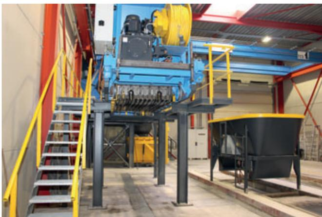
Vibrofinitrice Echo Precast Engineering in posizione di parcheggio
