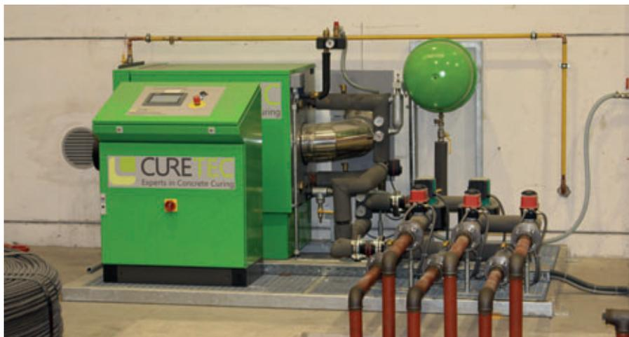
Sistema di riscaldamento CureTec
