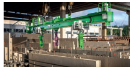
La traversa di sollevamento E9-16-5a è stata messa a punto per migliorare la sicurezza sul lavoro
