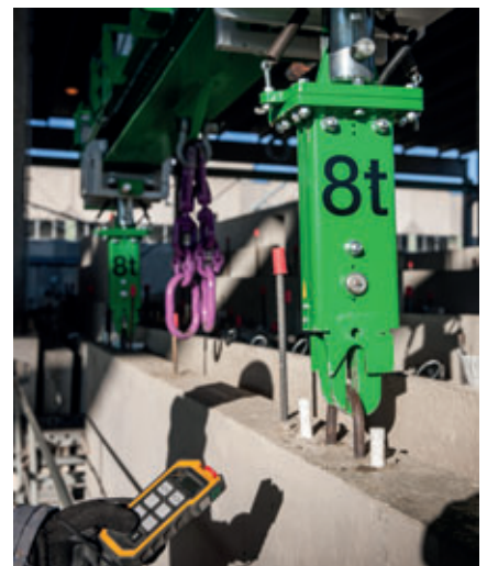
Il montaggio molto lungo delle catene non è più necessario, dato che la traversa di sollevamento di Elematic è dotata di ganci di sollevamento
