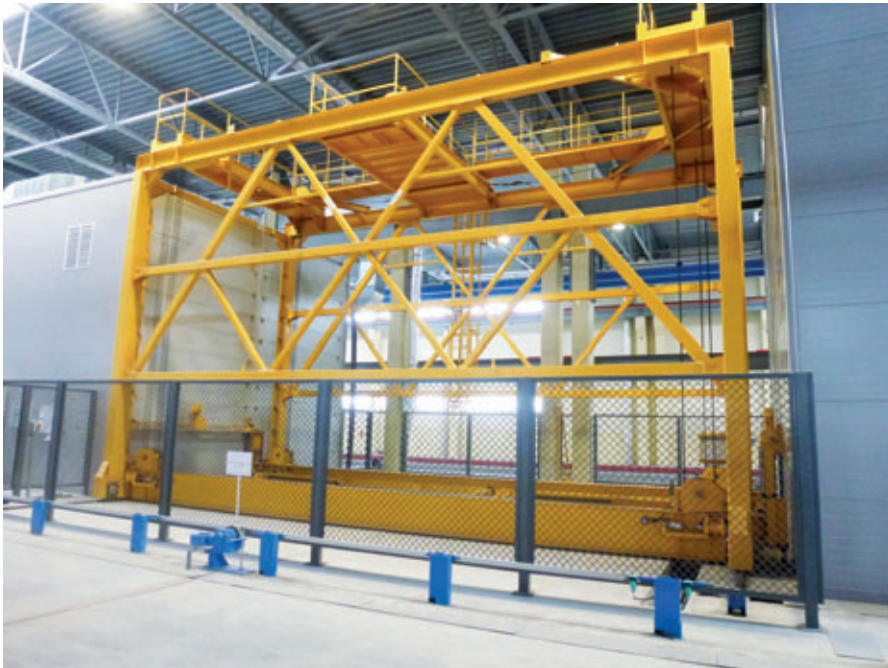
La plate-forme de levage dépose et prélève les palettes dans les rayonnages de durcissement.
