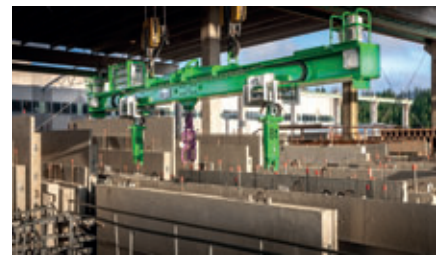
Le palonnier de levage Elematic E9-16-5a a été développé pour améliorer la sécurité du travail
