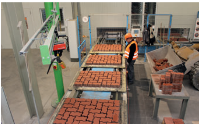
Immédiatement après la séparation, les deux lignes de transport des deux descenseurs sont de nouveau regroupées pour former une seule ligne.
