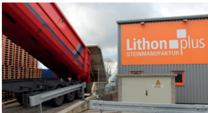
Les granulats livrés par camion sont directement basculés dans un silo de chargement d'une contenance de 22 m 3 .
