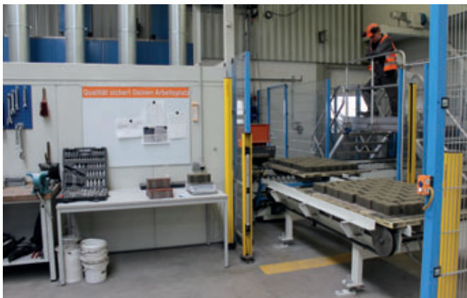
À des fins de contrôle de qualité, des planches de support peuvent être extraites de la ligne de production et acheminées directement derrière la machine de production de blocs.
