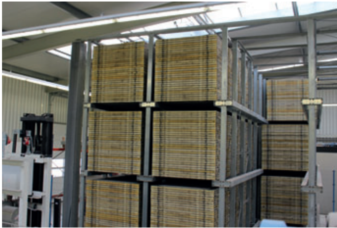
Rayonnage tampon pour planches prévu pour 2 800 planches de support
