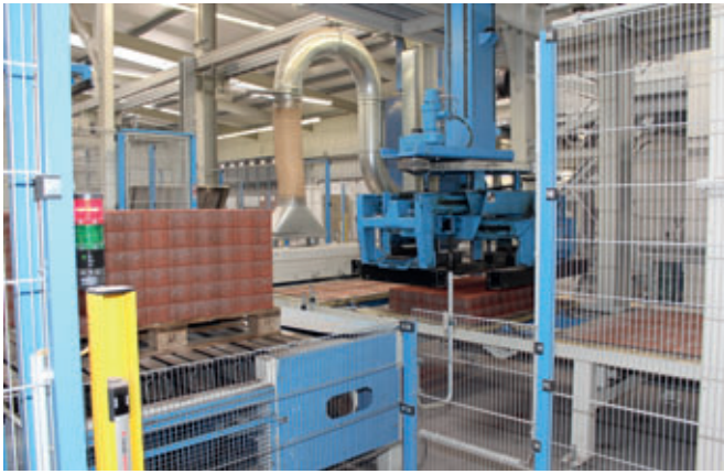
Les doubles couches sont emballées en paquets de blocs sur des palettes en bois Euro.
