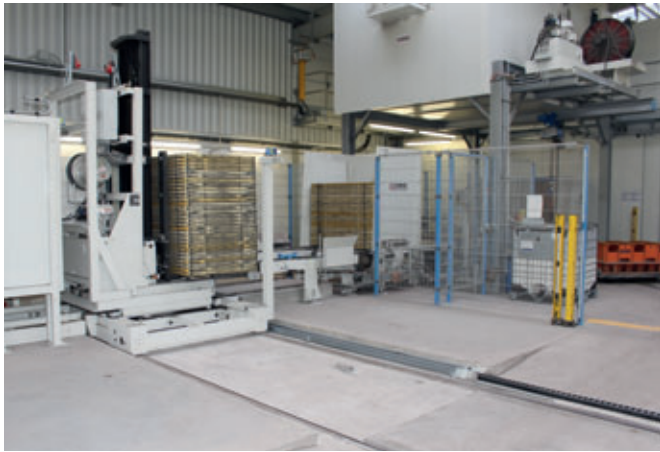
Le chariot transbordeur du rayonnage tampon pour planches alimente également la machine de production de blocs en planches de support Assyx.
