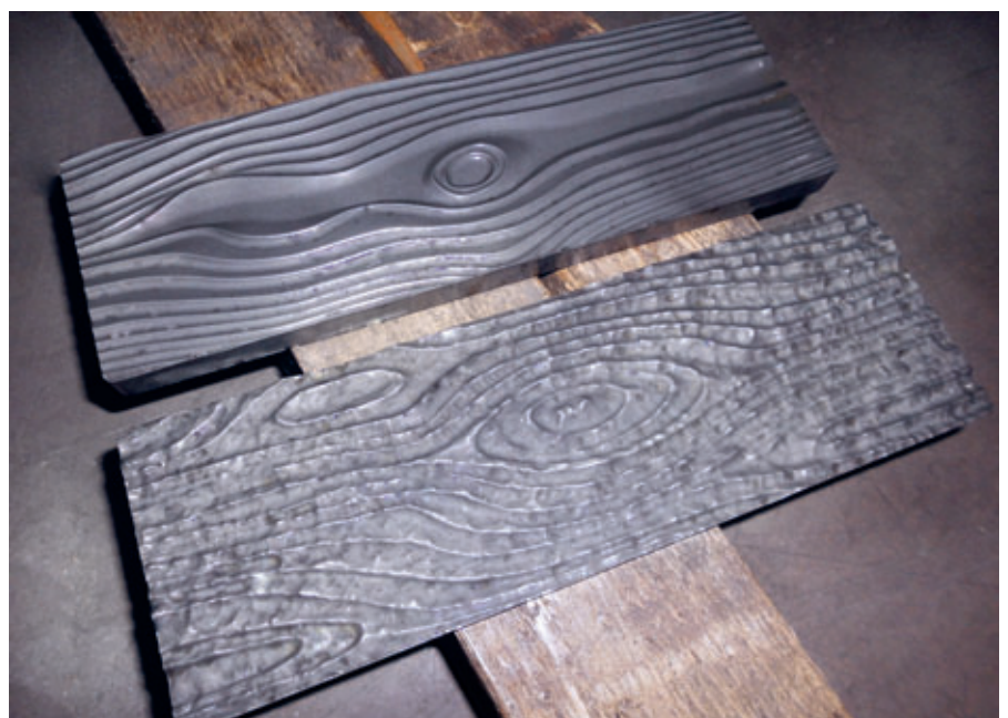
Échantillon d'empreinte pour essai de production réelle dans un moule à pavés en béton existant.
