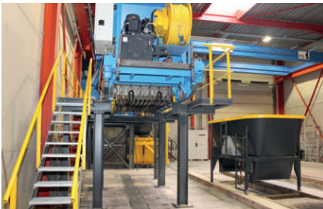
Máquina deslizante de Echo Precast Engineering en posición de reposo
