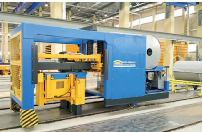
Con la ayuda de la sierra multiángulo se pueden acortar los elementos de hormigón fraguados a la longitud deseada.
