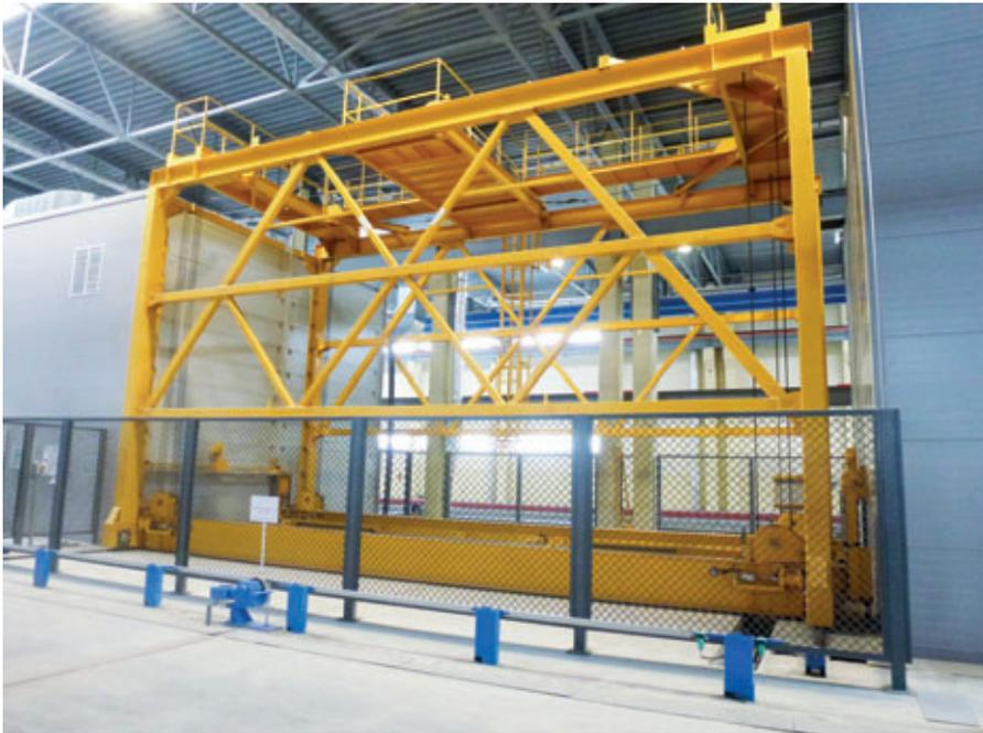
Las bandejas son almacenadas o retiradas de la estantería de fraguado con la plataforma móvil de elevación.
