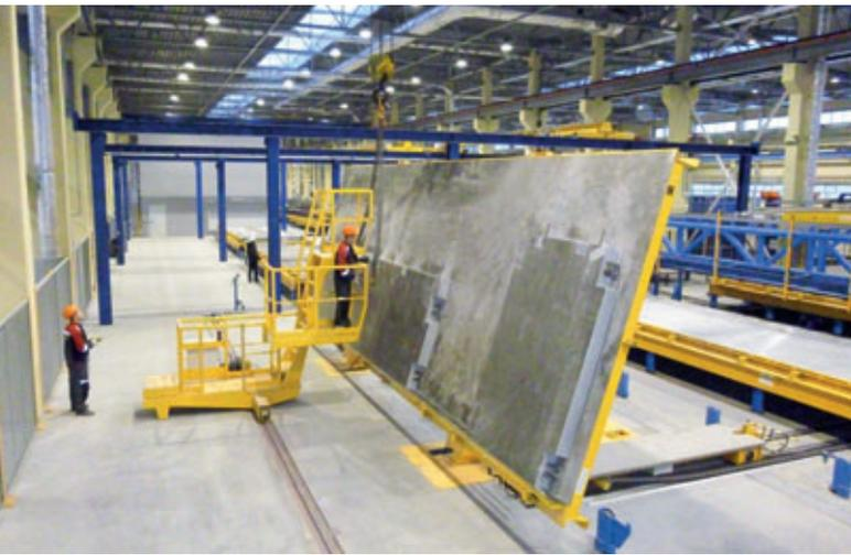
Para retirar los elementos de muro terminados, las bandejas son colocadas en posición prácticamente vertical con un dispositivo de basculación. Una escalera móvil facilita el proceso al operador.
