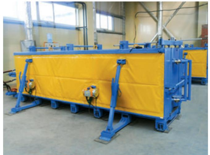
Para la fabricación de escaleras prefabricadas de hormigón, las nuevas naves de producción en Uliánovsk fueron equipadas con dos moldes gemelos, equipados cada uno con un sistema de compactación y calefacción.
