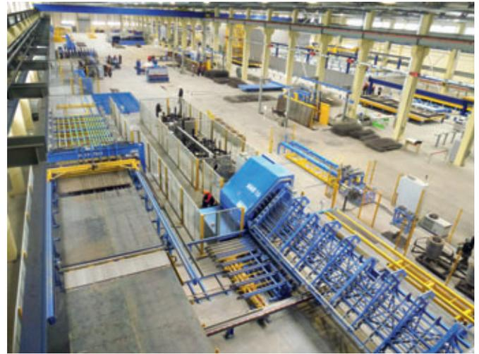
Con la instalación de soldadura de mallas M-System Evolution se producen las mallas de armadura necesarias en el momento justo y de un modo completamente automático. Los datos CAD necesarios son transferidos a la máquina por ebos.
