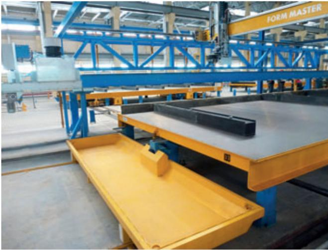
Con el sistema de robot Form Master, los encofrados son retirados tras finalizar un ciclo de producción de forma completamente automática, alimentados a una limpieza de limitadores y colocados nuevamente de forma exacta sobre la superficie de encofrado de la bandeja para una nueva ocupación.
