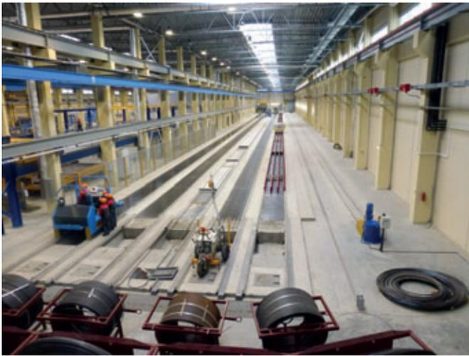
En un total de 5 vías de producción, con una longitud de 126 m cada una, se fabrican elementos de hormigón pretensado con una máquina deslizante.
