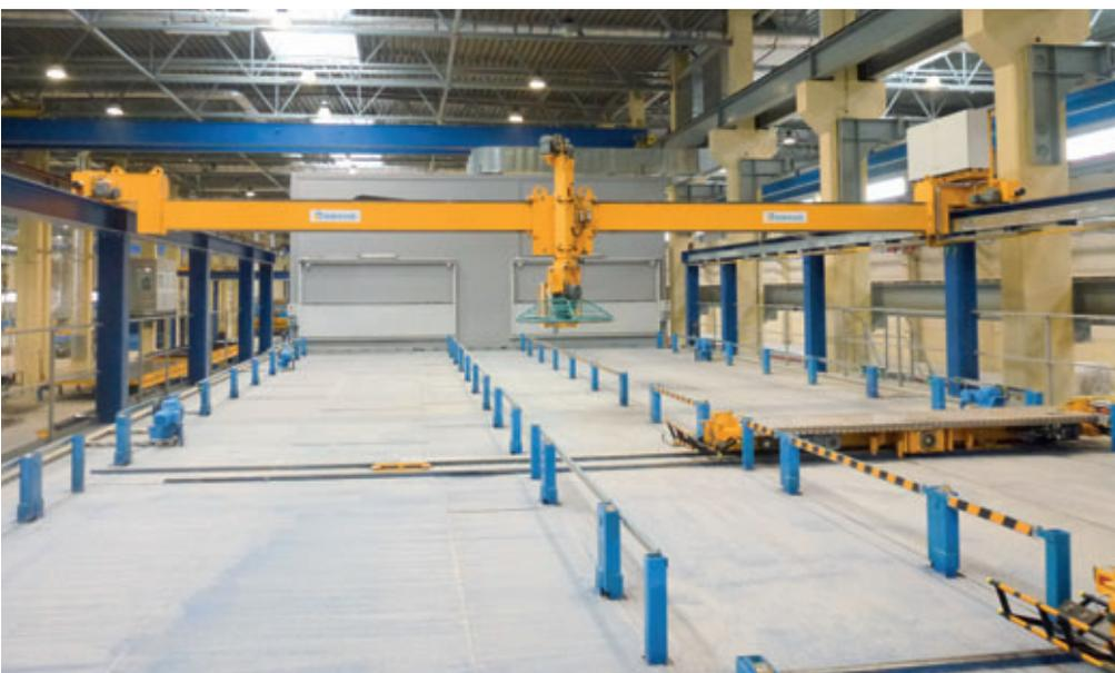
Tras el prefraguado del hormigón en la cámara de fraguado previo, las bandejas son desplazadas al 2º nivel con la plataforma móvil de elevación. Allí se dispone de una alisadora y cuatro puestos de alisado para alisado fino.
