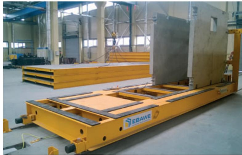
Con un carro de salida se transportan los elementos prefabricados de hormigón al almacén exterior.
