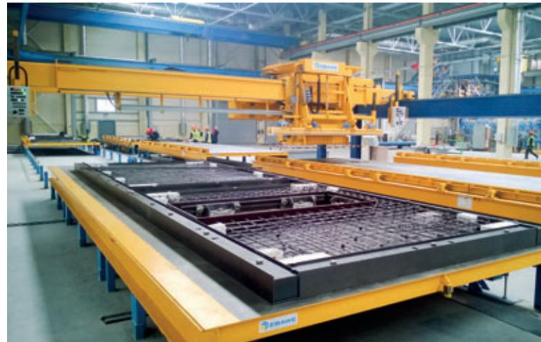
La bandeja encofrada se encuentra lista para el hormigonado. El hormigón es alimentado uniformemente a través de un sistema de tornillo sin fin en función de los datos enviados por ebos. La capa de hormigón es rascada y alisada mediante un travesaño oscilante hasta el nivel de altura deseado.
