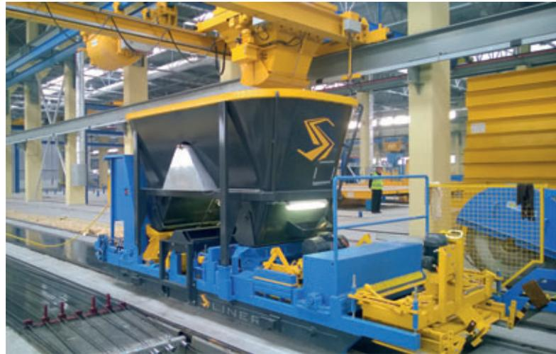
Con el Slipformer se pueden fabricar placas alveolares pretensadas con un espesor de 6 a 60 cm. Además, esta máquina también se utiliza para una gama de producción completamente diferente, para la fabricación de vigas maestras, dinteles, pilotes hincados, etc. La compactación tiene lugar en la máquina deslizante mediante técnicas de vibración y movimientos del conjunto de tubos y moldes.
