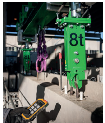
El montaje de las cadenas, que requería mucho tiempo, ya no es necesario gracias a que el travesaño elevador de Elematic está equipado con ganchos de carga
