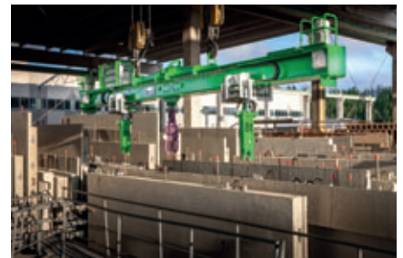
El travesaño elevador Elematic E9-16-5a fue desarrollado para mejorar la seguridad laboral
