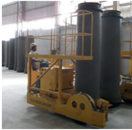
El segundo operario a cargo de la fabricación de tubos transporta los productos frescos a la zona de curado con el carro de transporte.
