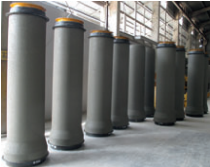
Los tubos de hormigón suelen permanecer un día laborable en la zona de curado.
