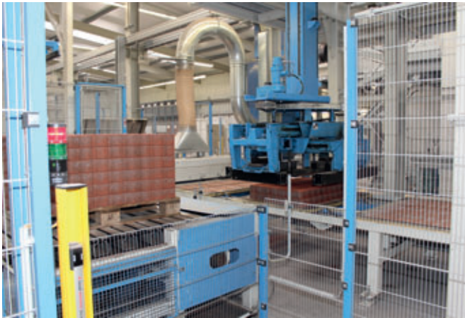
Las capas dobles son colocadas sobre europalets de madera para formar paquetes de bloques.
