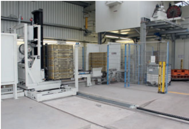
El carro multiforca de la estantería temporal de bandejas también alimenta bandejas Assyx a la máquina de producción de bloques.
