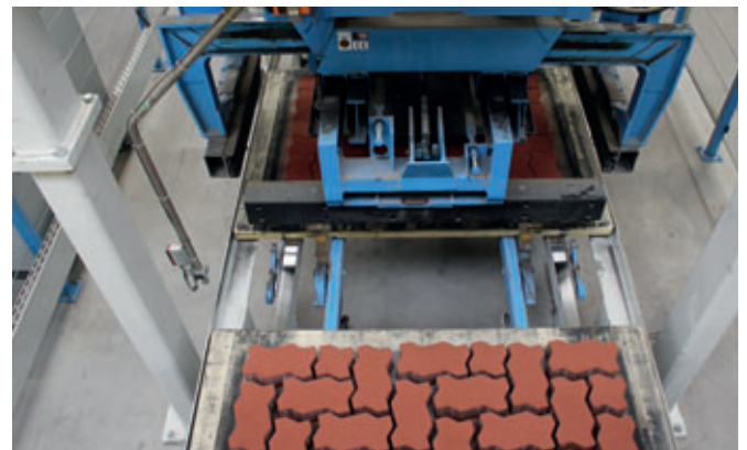
En esta estación, los bloques son empujados sobre la bandeja.
