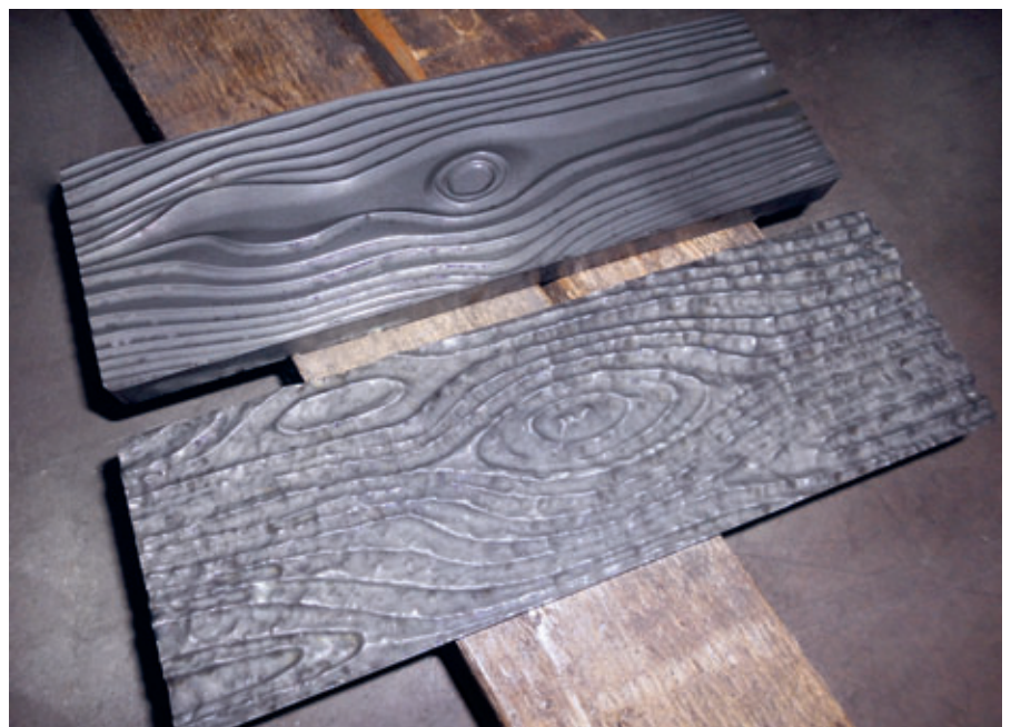
Sellos prototipo para una producción de prueba real en un molde de bloque de hormigón existente.
