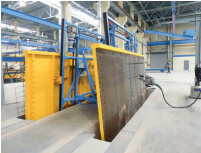
Vertikaler Schweißmanipulator zur Herstellung von Bewehrungskörben
