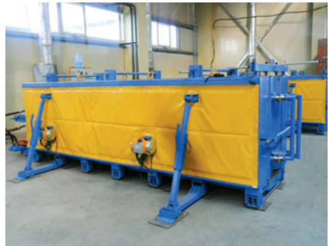
Zur Herstellung von Betonfertigteiltreppen wurden die neuen Produktionshallen in Uljanovsk mit zwei Zwillingsformen ausgestattet, jeweils ausgerüstet mit einem Verdichtungs- und Heizungssystem.
