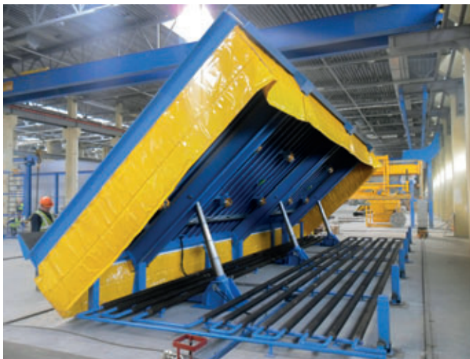
Das neue Werk in Uljanovsk verfügt auch über zwei Kipptische, die mit einem Verdichtungs- und Heizungssystem ausgestattet sind.
