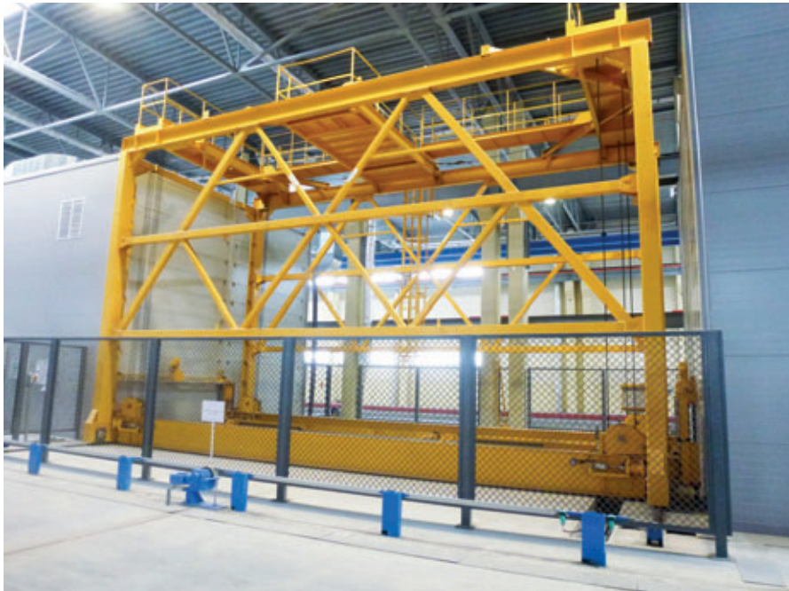
Mit der Hubschiebebühne werden die Paletten in das Härteregal ein- und ausgelagert.
