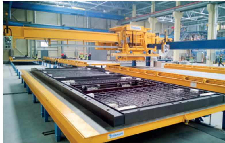
Die fertig geschaltete Palette steht zum Betonieren bereit. Der Beton wird über ein Schneckensystem gleichmäßig entsprechend der von ebos geschickten Daten ausgetragen. Mit einer Vibrations-Glätthohle wird die Betonlage auf das gewünschte Höhenniveau abgestrichen und geglättet.
