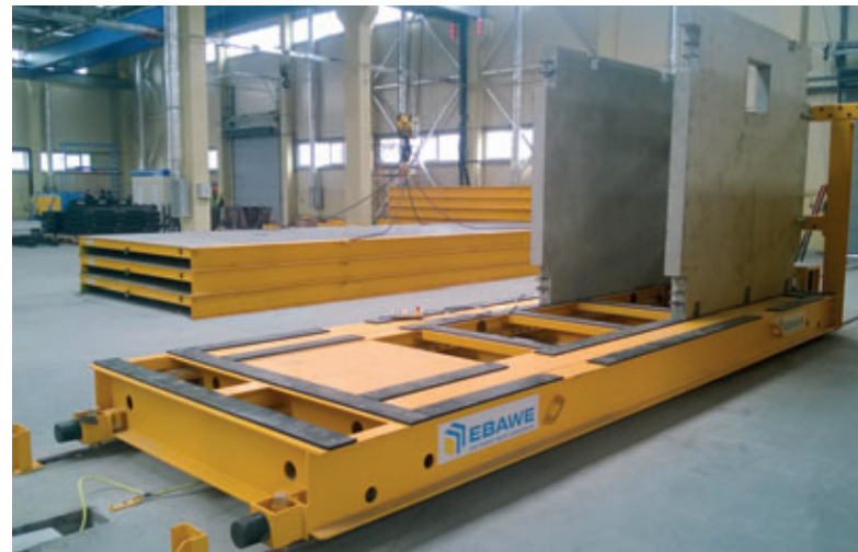
Mit einem Ausfahrwagen werden die Betonfertigteile ins Freilager befördert.
