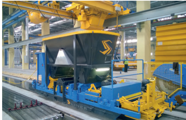
Mit dem Slipformer können Spannbetonfertigteile von 6 bis 40 cm Stärke hergestellt werden. Darüber hinaus wird diese Maschine auch für eine komplett andere Produktpalette eingesetzt zur Herstellung von Unterzügen, Stürzen, Rammpfählen, usw. Die Verdichtung erfolgt beim Gleitfertiger durch Vibrationstechnik und Bewegungen des Rohr- und Formsatzes.
