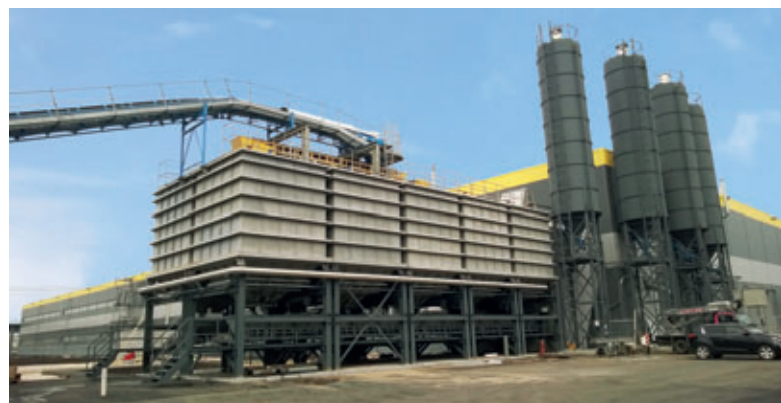
Für die Versorgung mit Frischbeton investierte Zapad auch in ein komplett neues Mischanlagen-system, welches den erforderlichen Beton für die komplette Produktpalette bereitstellt.
