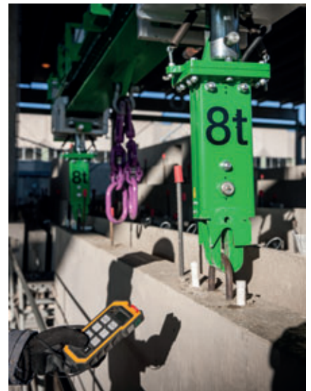
Das zeitraubende Montieren der Ketten ist nicht mehr erforderlich, da die Hubtraverse von Elematic mit Lasthaken ausgestattet ist.
