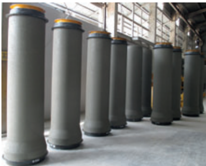
Die Betonrohre bleiben üblicherweise einen Arbeitstag im Aushärtebereich.
