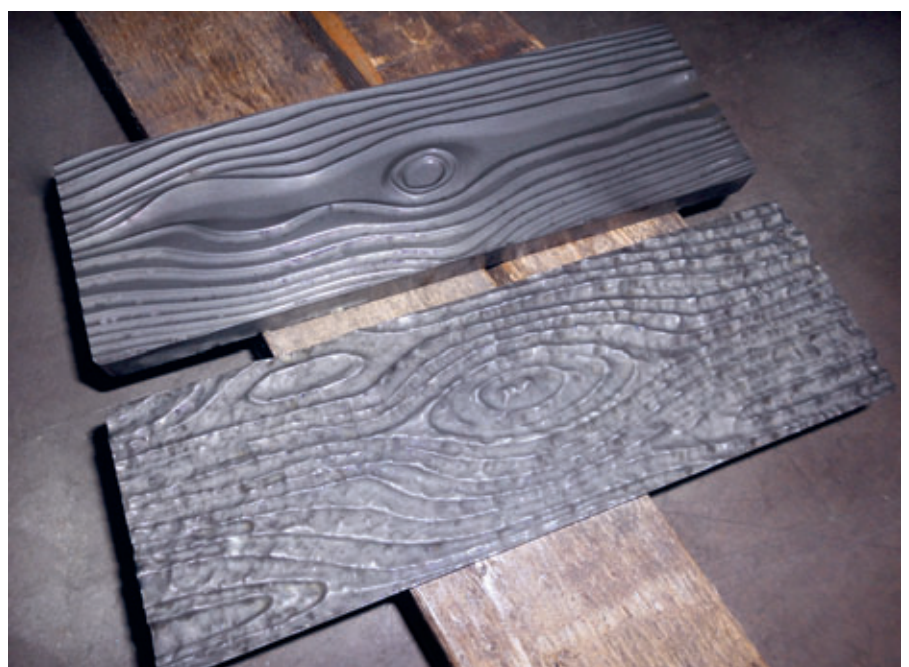
Musterdruckplatte zur realen Testproduktion in einer vorhandenen Betonsteinform
