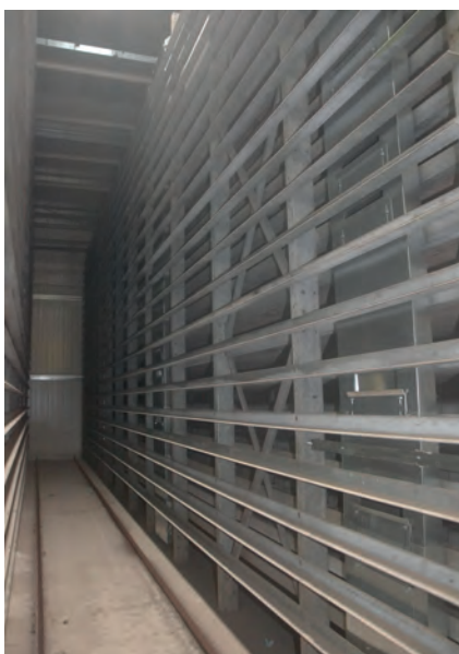
Снимки, сделанные во время выдержки при температуре 35°C и относительной влажности 100% - сухие направляющие, пол и стеллажи. Воздуховод с вентиляционными прорезями находится справа
