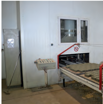
Камера тепловлажностной обработки: вход на мокрой стороне (свежеотформованные изделия), выход на сухой стороне (затвердевшие изделия), включая окно, теплоизоляционную стену и вытяжку с нагревательным колпаком во избежание попадания влаги на свежие изделия
