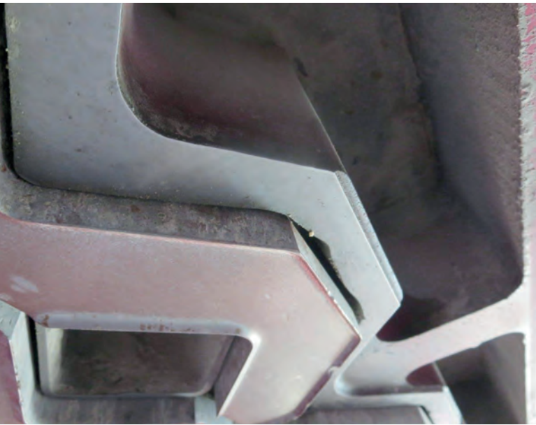
Дефект «слоновья стопа» на нижней кромке формы
