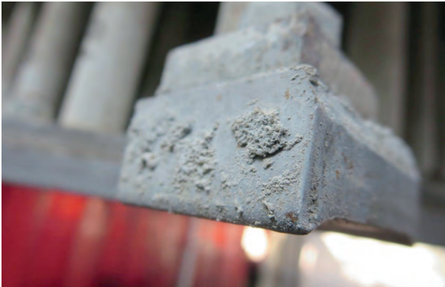
Типичные рисунки износа: одностороннее истирание фаски
