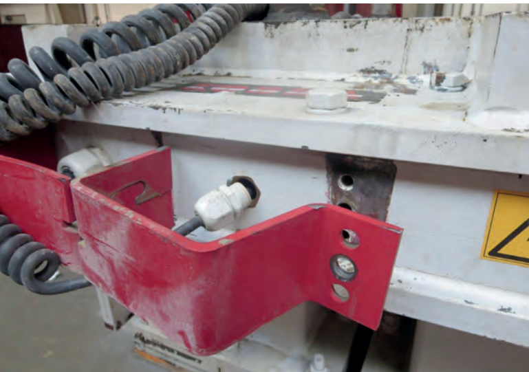
Повреждения в результате неправильного обращения/техобслуживания
