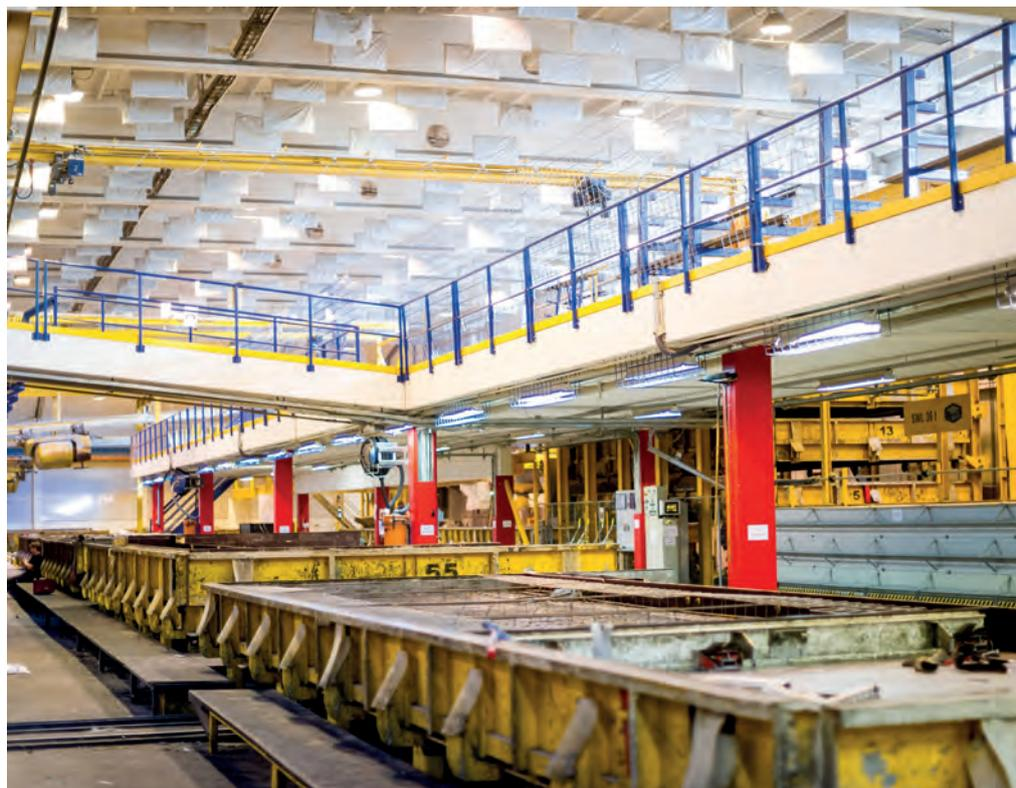
Суточная выработка всего завода составляет примерно 750 тонн, при этом с 2002 г. все процессы контролируются при помощи надежного программного обеспечения EliPlan. Для производства фасадов на заводе установлено 25 стенов (10 м x 4 м), позволяющих бетонировать элементы толщиной до 450 мм
