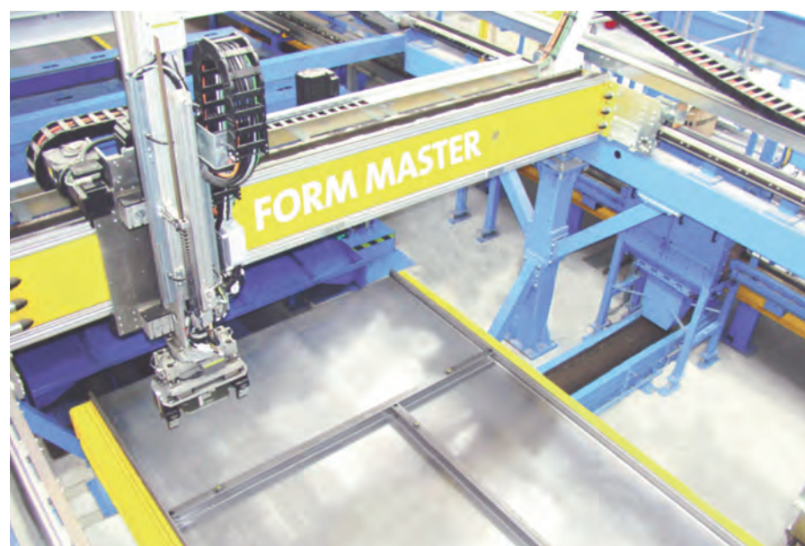
Опалубочная система Infinity Line®, разработанная и запатентованная группой компаний Progress Group, отличается инновационностью и эффективностью, позволяя наладить поточное производство ЖБИ без полистироловых вкладышей
