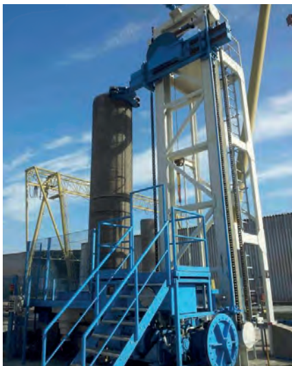
Вертикальная установка для прокладки напрягающих канатов на заводе Hydroatimpagement Rouiba/Алжир для выпуска труб диаметром от DN 600 до DN 2000, монтажная дна 6 м
