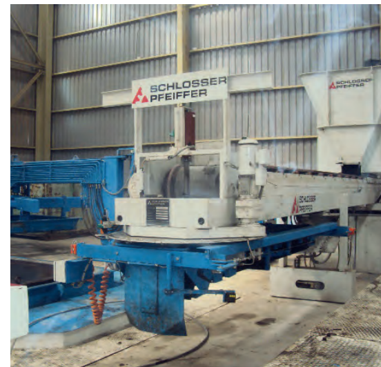
Универсальная установка Variant 4000 для крупноформатных труб и рам на заводе Sarl Etber, Буира
