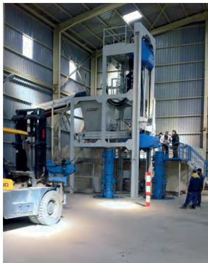
Радиальный пресс RP 1225 для изготовления канализационных труб с интегрированным уплотнением DN 300 – 1200 мм, монтажная длина 2,5 м, на заводе Sarl Etber, Буира
