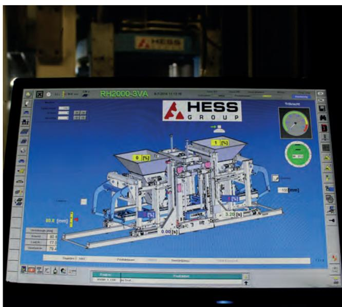
С пульта управления можно отслеживать все процессы на камнеформовочной линии RH 2000-3 MVA
