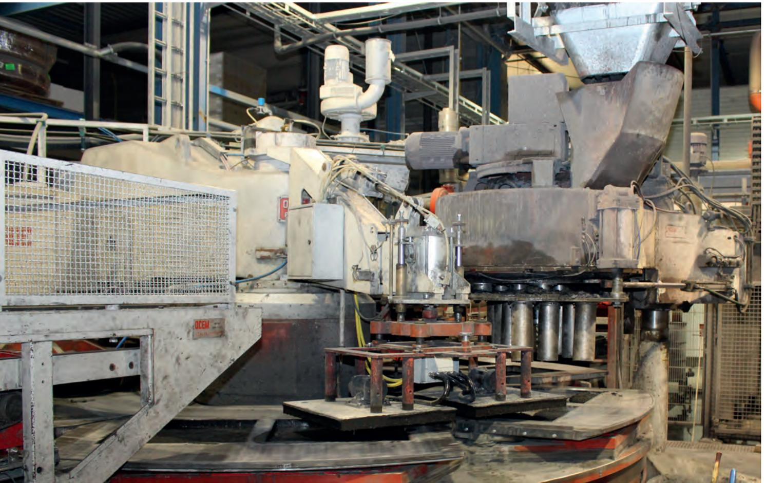
Герметичный пресс SR-Schindler с поворотным столом и усилием 14 000 кН
