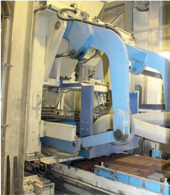
Hess RH 2000-3 MVA, размер поддона 1450 x 1250мм, введена в эксплуатацию в середине 2011 г.
