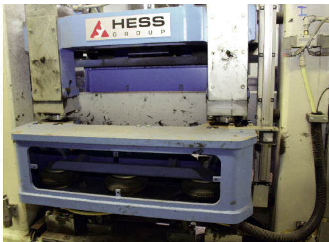
Produkcja kostki brukowej za pomocą trzeciej wibroprasy RH 2000 w firmie Excluton.
