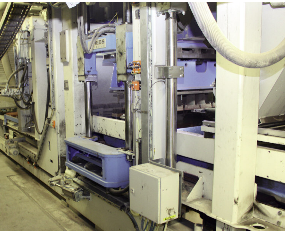
3. Wibroprasa RH 2000-3 MVA firmy Hess, wielkość podkładów produkcyjnych 1450x750mm, rozruch na początku 2014 r.
