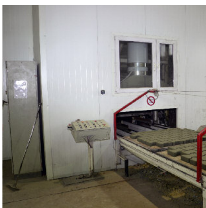
Wejście Strona Mokra Komory Dojrzwania / Wyjście Strona Sucha dla świeżych/stwardniałych wyrobów betonowych; łącznie z oknem, izolowaną ścianą i wywiewem z podgrzewanym okapem w celu zapobieżenia wykroplenia się wilgoci z obszaru produkcji na powierzchni wyrobów.
