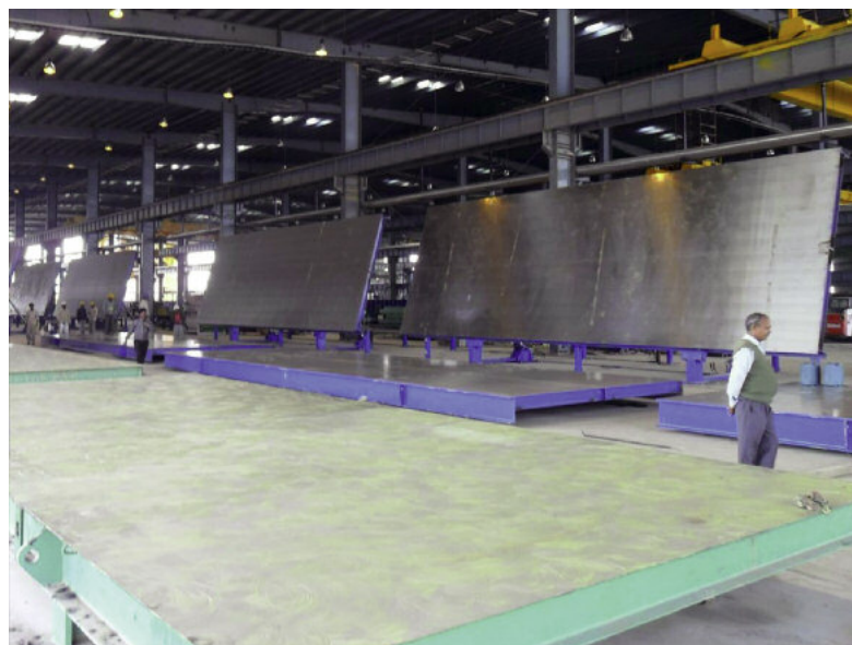
Firma tecnocom dostarczyła w sumie 36 stołów uchylnych TTE do zakładu firmy Amrapali Precast na południowym wschodzie Nowego Delhi.
