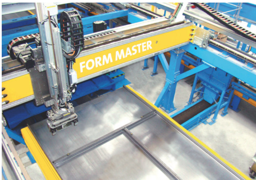
Nowy system szalunków Infinity Line, opracowany i opatentowany przez Grupę Progress, umożliwia szalowanie prefabrykatów betonowych w pełni wykorzystując powierzchnię podkładu i praktycznie bez wykorzystania profili szalunkowych.
