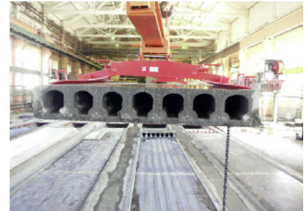
Podniesienie gotowej sprężonej płyty kanałowej.
