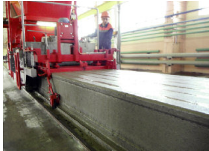
Ślizgowy system betonujący przystosowany jest nie tylko do produkcji sprężonych płyt kanałowych o grubości od 60 do 600 mm, ale można za jego pomocą również produkować pale, nadproża okienne oraz betonowe płyty drogowe.
