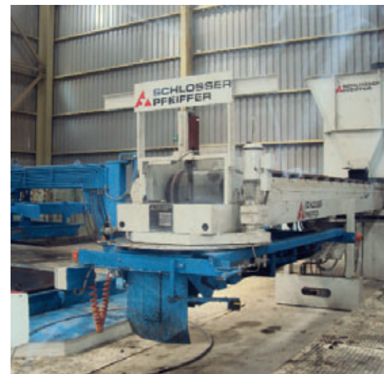
Variant 4000, macchina universale per tubi e passaggi rettangolari di grandi dimensioni presso Sarl Etber, Bouira
