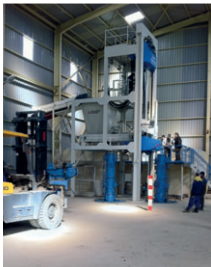
Pressa radiale RP 1225, macchina ad alte prestazioni per tubi per fognature con guarnizione integrata DN 300 – 1200 mm, con una lunghezza costruttiva di 2,5 m presso Sarl Etber, Bouira
