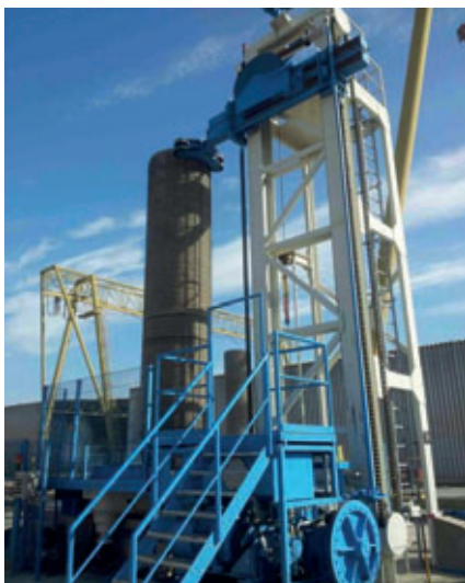
Macchina di precompressione verticale nello stabilimento Hydroamangement Rouiba/Algeri per l'avvolgimento di tubi centrali da DN 600 a DN 2000, con una lunghezza costruttiva di 6 m.
