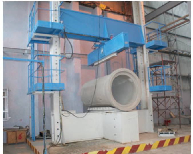
Pressa per la prova di schiacciamento
