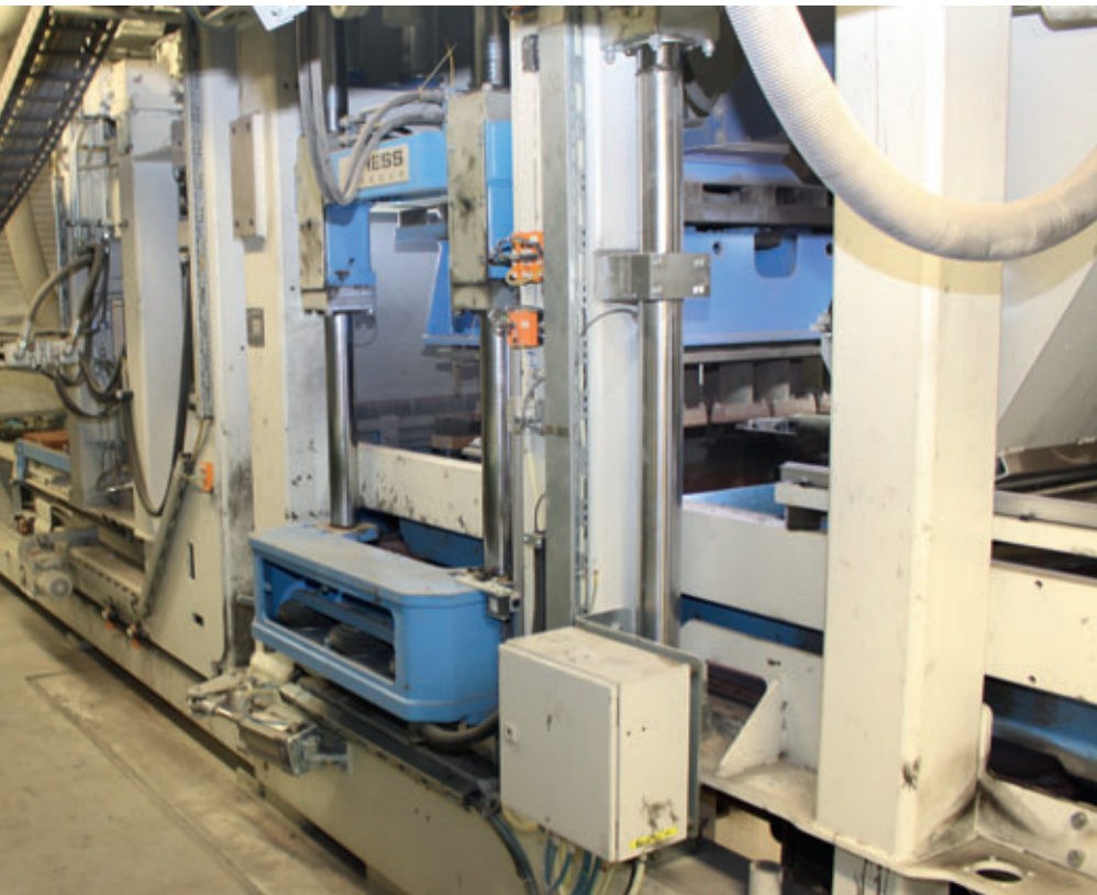
3. Hess RH 2000-3 MVA, dimensioni piastre di appoggio 1450x750mm, entrata in funzione all'inizio del 2014
