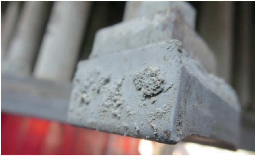
Schemi tipici di usura: usura unilaterale degli smussi
