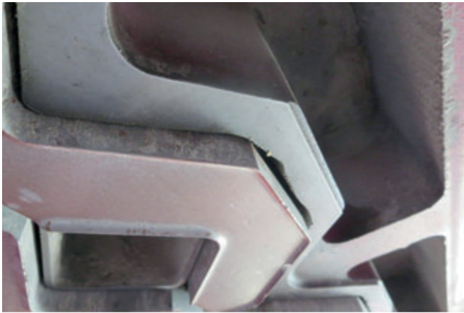
“Piedi d’elefante” sullo spigolo inferiore dello stampo
