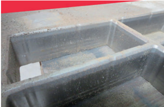
Usura nell'area di compattazione
