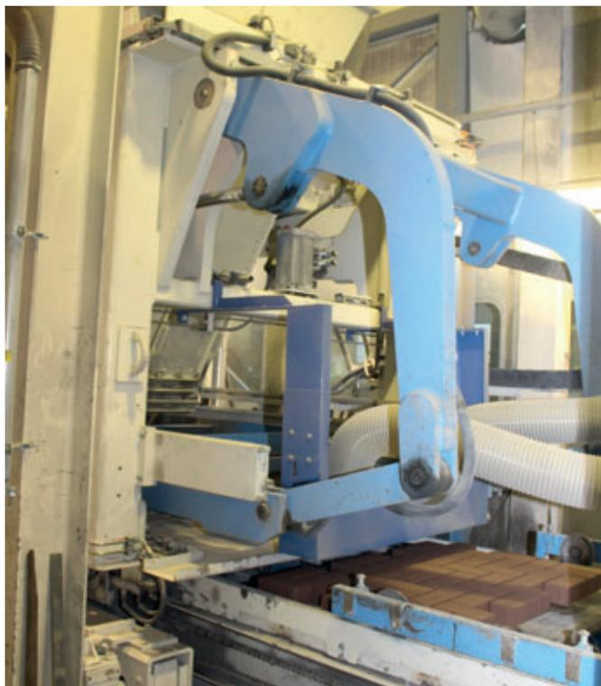
1<sup>ère</sup> machine RH 2000-3 MVA de la société Hess, dimensions des planches de support : 1.450 x 1.250 mm, mise en service : mi-2011
