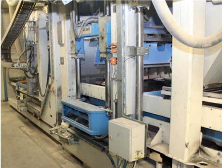
3<sup>ème</sup> machine RH 2000-3 MVA de la société Hess, dimensions des planches de support : 1.450 x 750 mm, mise en service : début 2014
